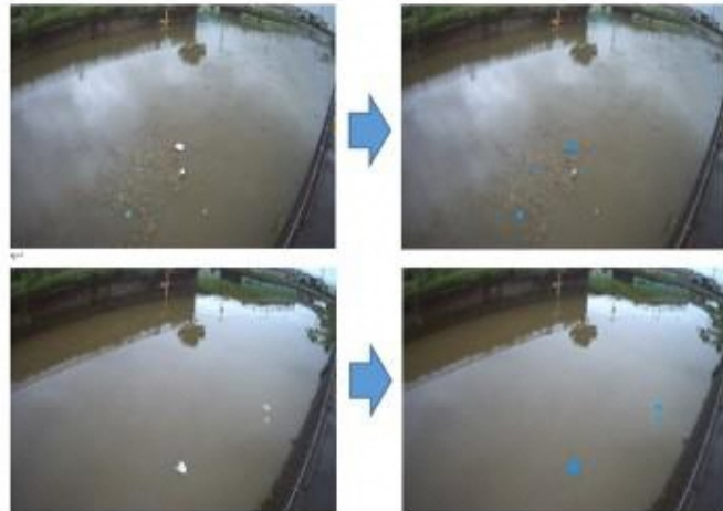
元画像（左）とAIによりごみと判別された部分を色付けた画像（右） （地点：恩智川中流（カメラ設置箇所：恩智川治水緑地））
